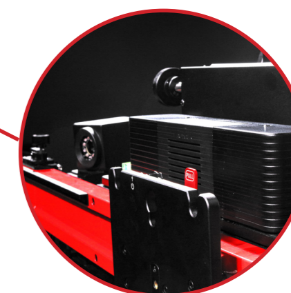
Torretta di regolazione del beccheggio, rollio, imbarcata e centraggio della barra
