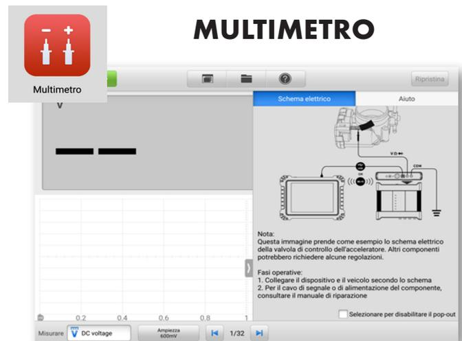
La funzione multimetro prevede tutte le funzioni di lettura : tensione, amperaggio, resistenza, prova diodi, continuità, verifica di frequenza con visualizzazione grafica, e supporta pinze amperometriche.
