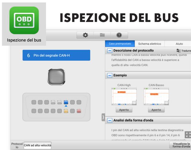
È possibile verificare lo stato della linea CAN direttamente dalla presa EOBD.
